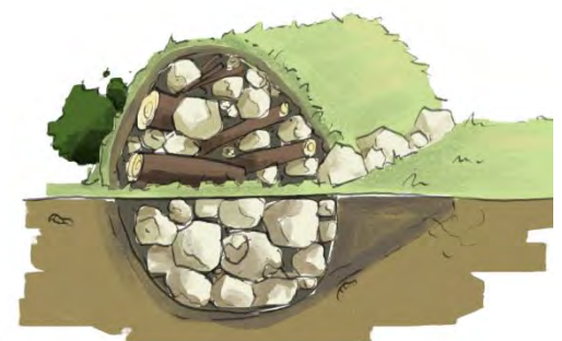
Schéma de principe d'un hibernaculum (©Biotope)
